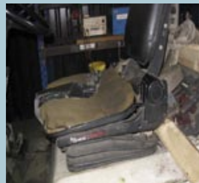
Voorbeeld van slecht onderhoud! Zitting van nog in gebruik zijnde heftruck.
